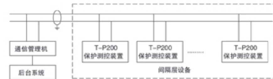
图5.1 T-P200系列综合保护测控装置通信网络示意图
