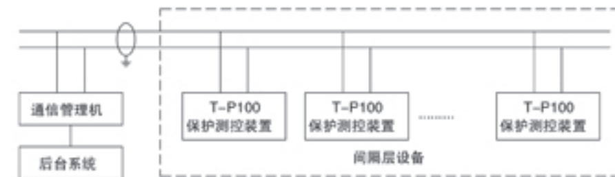
图5.1 T-P100系列综合保护测控装置通信网络示意图
